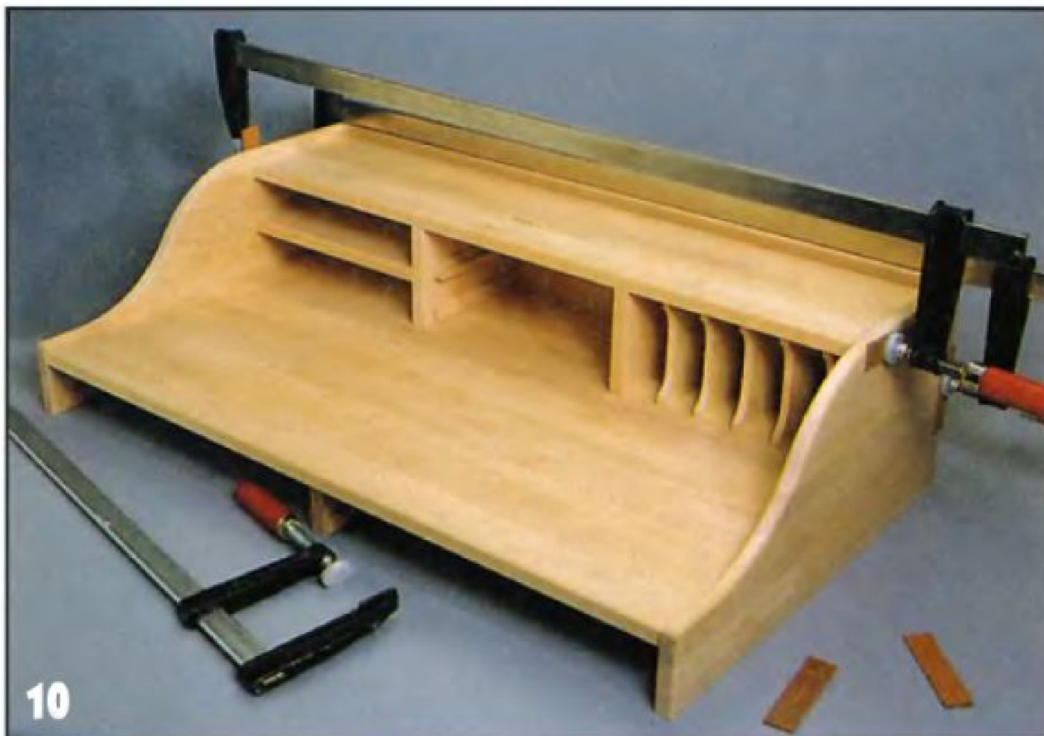
Установив промежуточные перегородки и фанерные перегородки правого отделения, монтируют верхнюю крышку. После этого, вставив полку левого отделения, крепят боковые стенки. Собранный верхний элемент стягивают струбцинами на время сушки клея.
