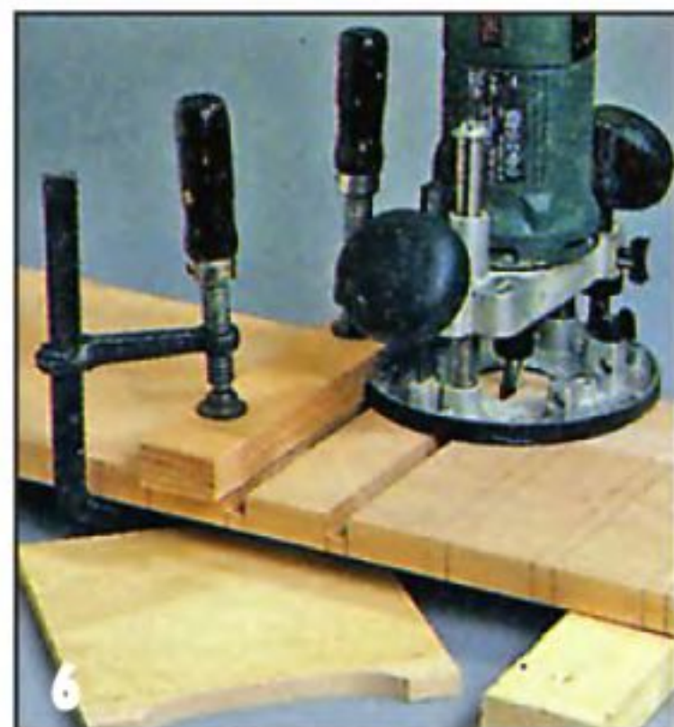
Пазы под перегородки выбирают пазовой фрезой, перемещая машинку вдоль направляющего упора. Ширина пазов — 10 мм.
