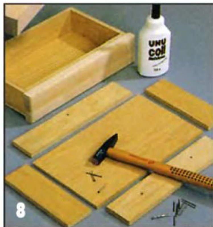
Стенки выдвижных ящиков склеивают друг с другом и с дном. Соединения усиливают отделочными гвоздями. К передней стенке каждого ящика крепят фасадный щиток, ввёртывая шурупы с внутренней стороны стенки.
